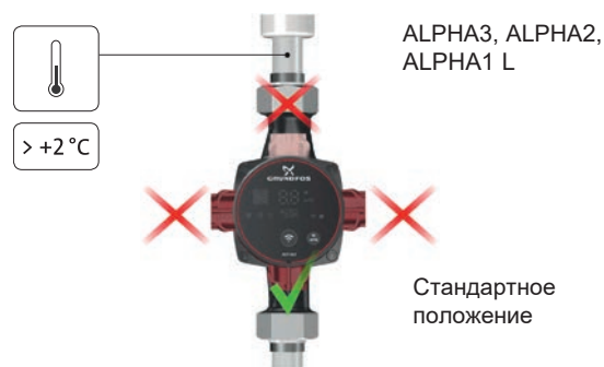
Рис. 17 Возможное положение блока управления для системы отопления
