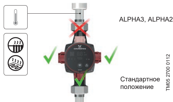
Рис. 18 Возможное положение блока управления для системы охлаждения и кондиционирования воздуха
