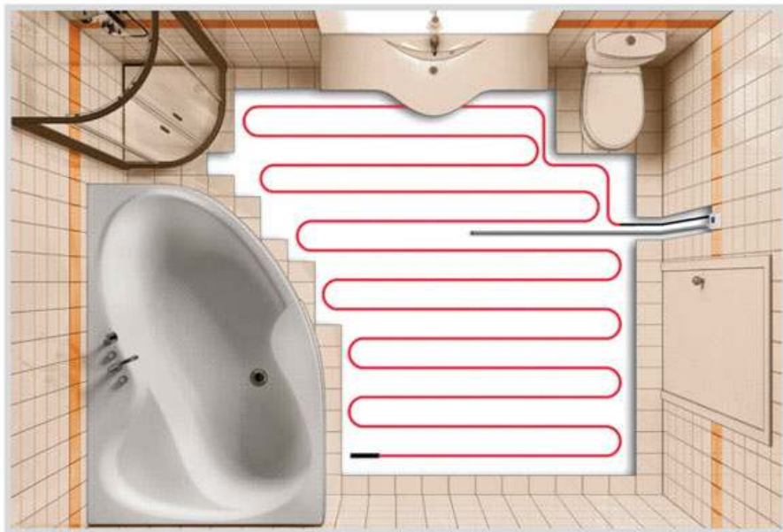
Схема укладки кабеля на свободную площадь
