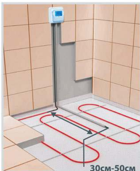
Схема укладки датчика температуры в гофрированной трубке
