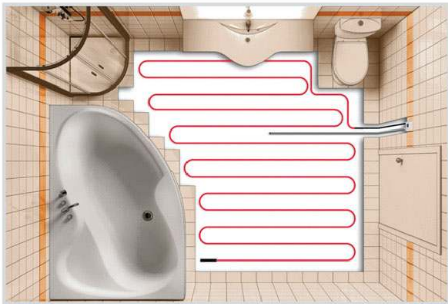
Схема укладки кабеля на свободную площадь
