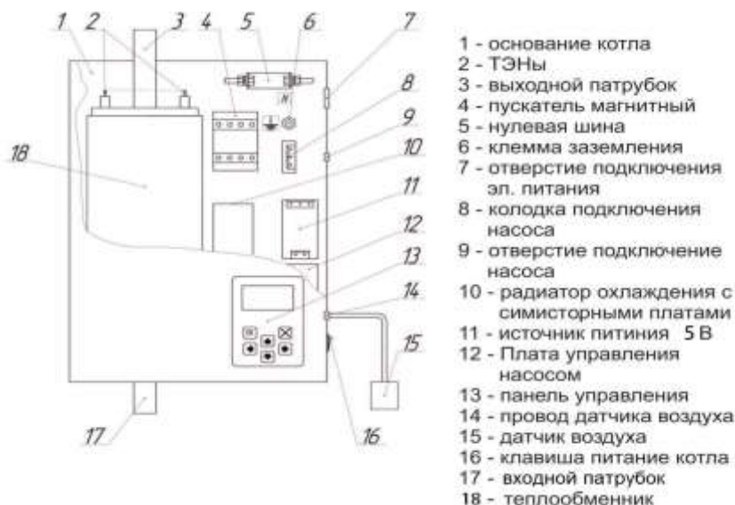
Рисунок 1. Устройство отопителя РЭКО серии П
