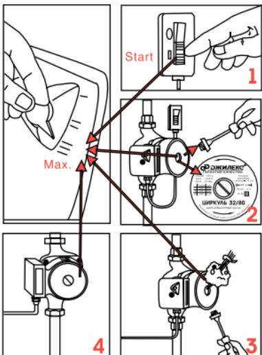
обратной стороне электромотора (рис.3) - воздух начнет стравливаться через прорезь между валом мотора и подшипником. После того как начнет вытекать теплоноситель, необходимо закрутить болт, открыть вентили со стороны всасывания и со стороны нагнетания. В зависимости от условий работы насоса или системы в целом (температура среды), насос может сильно нагреваться.
