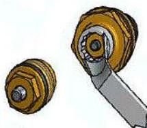
6.4. При течи из-под штока терmostатического клапана, головка клапана может быть снята, отремонтирована или заменена. Головка отвинчивается с помощью гаечного ключа. Сливать воду из коллектора при этом не нужно.
