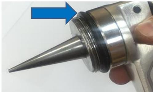
2. Развести рукоятки расширителя до упора и накрутить насадку на расширитель до соприкосновения с ограничительным кольцом
