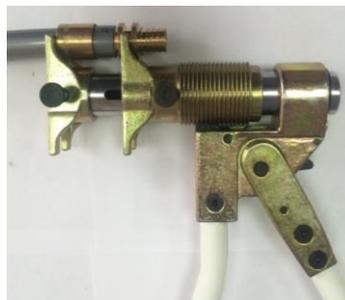
11. С помощью подвижной рукоятки пресс инструмента произвести запрессовку монтажной гильзы. В процессе монтажа необходимо придерживать место соединения в тисках в правильном положении, во избежание перекоса соединения.
