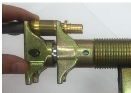
13. Перевести предохранитель в пресс-инструменте в положение вниз.
