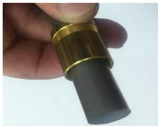
6. Вставить штуцер расширительной насадки в трубу до упора
