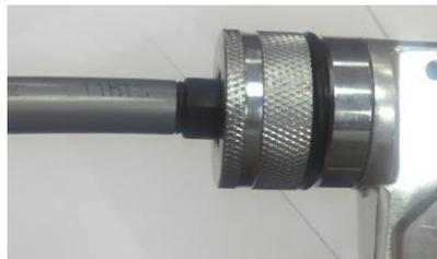
7. Свести рукоятки расширителя до конца и произвести расширение трубы в три приема с поворотом 30 градусов. Труба из сшитого полиэтилена РЕ-Ха имеют память формы, поэтому соединение необходимо делать быстро, чтобы трубы не вернула первоначальную форму.
