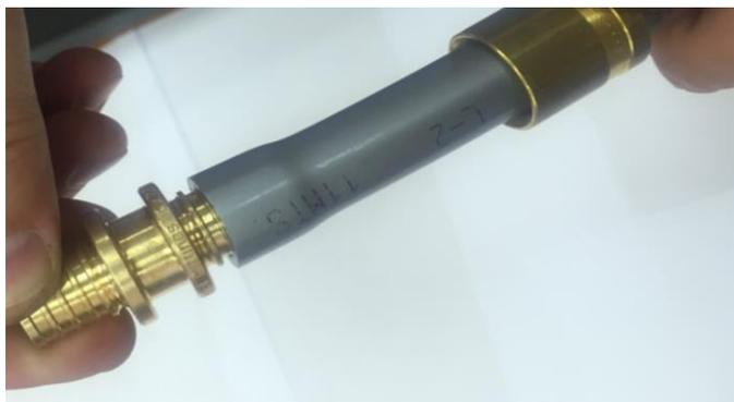
9. Перевести предохранитель в пресс-инструменте в положение вверх.
