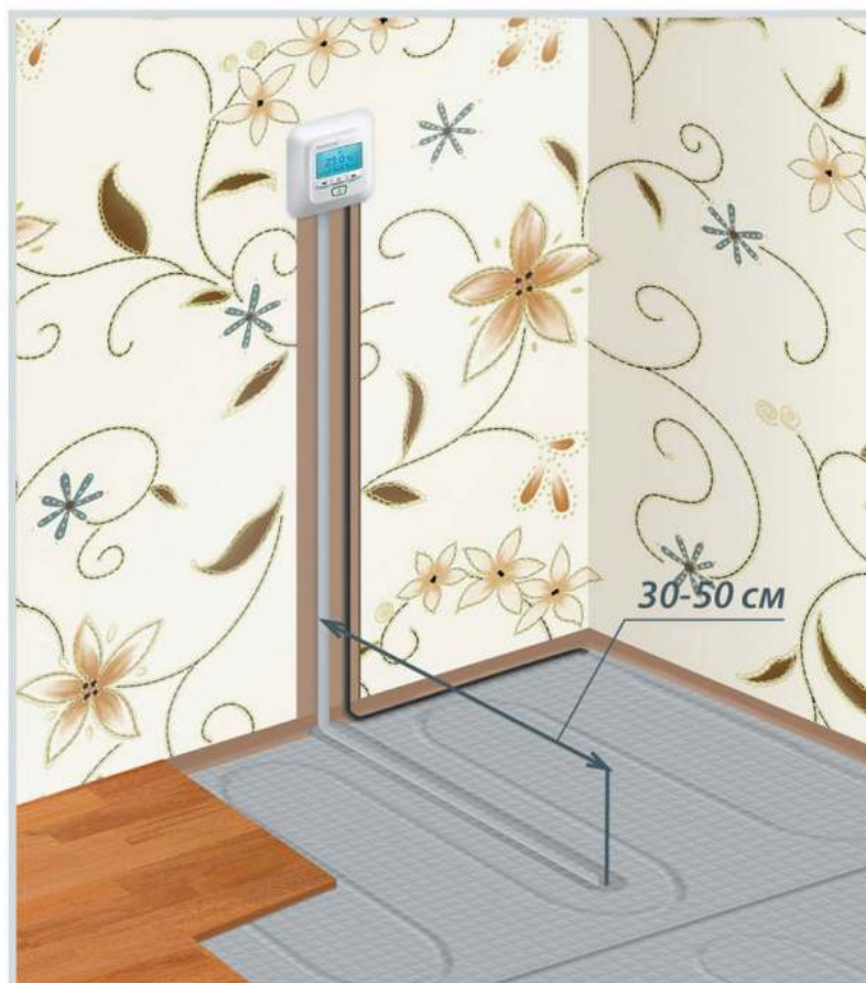
Схема укладки датчика температуры в гофрированной трубке
