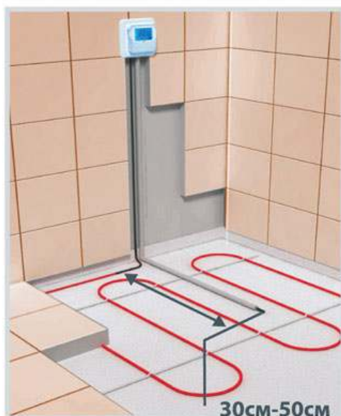
Схема укладки датчика температуры в гофрированной трубке
