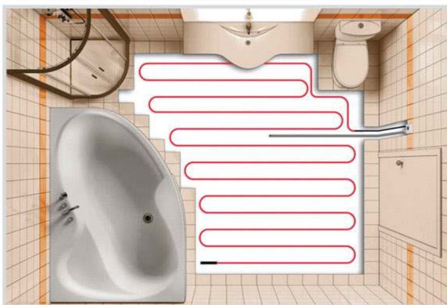
Схема укладки кабеля на свободную площадь
