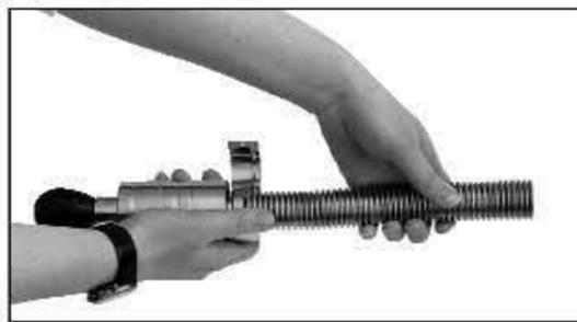
Перед обработкой фланца необходимо надеть накидную гайку на трубу. Для изготовления надежного фланца предпоследняя впадина волны вставляется в губки тисков.
