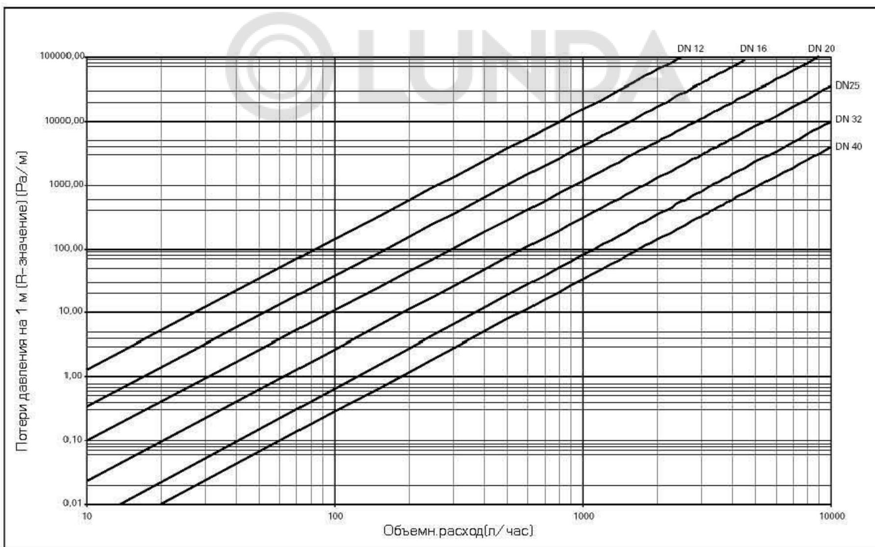
**Пример:** гофрированная труба из высококачественной стали DN 20
