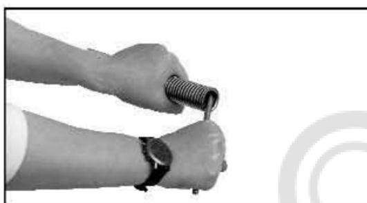
Внутренние заусенцы удаляются с помощью стержня для отбортовки.
