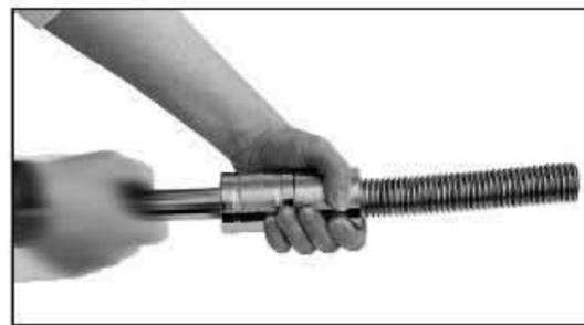
Губки тисков зажимаются\*. Посредством перемещения ударного болта создается фланцевое соединение. Затем еще раз вставьте последнюю впадину волны и повторите процедуру, для того чтобы фланцевое соединение было устойчивым.
