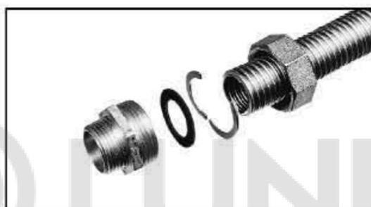
Вставное кольцо вставьте в первую впадину волны, привинтите винтовую деталь и прижмите, отвинтите винтовую деталь, вставьте уплотнение, законтрите винтовые детали. – Все готово!
