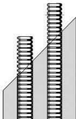
Гофрированная труба из высококачественной стали, поставляется с завода длиной максимум 20 м, высокотемпературостойкая каучуковая изоляция выдерживает максимум 175оС [кратковременно], толщина изоляции 13 мм с кабелепроводом.
