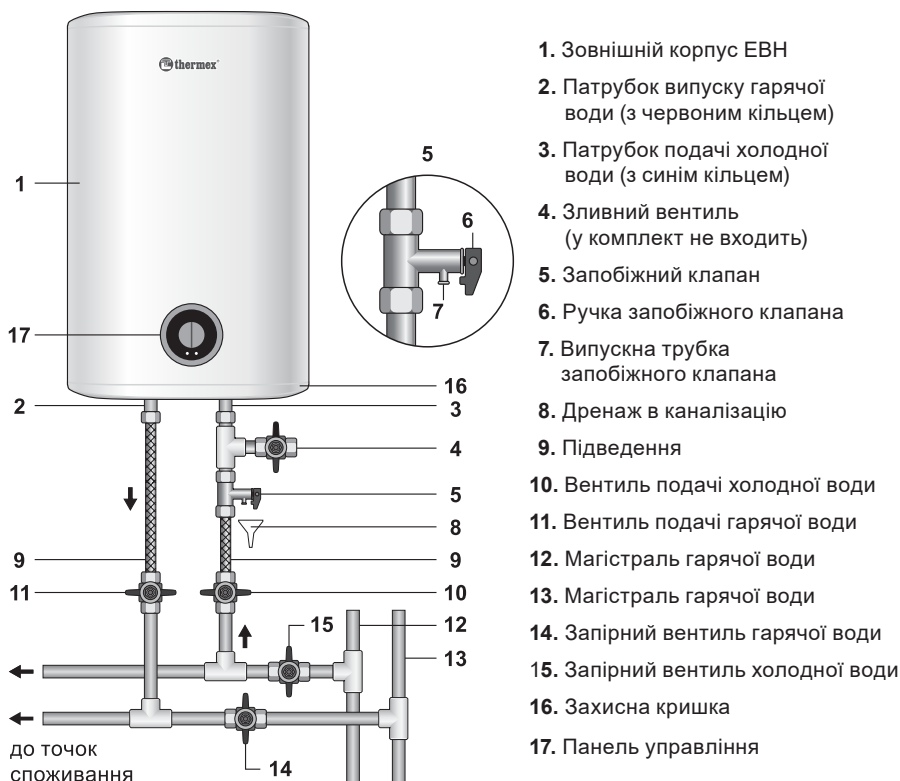
Малюнок 2. Схема підключення ЕВН до водопроводу.
