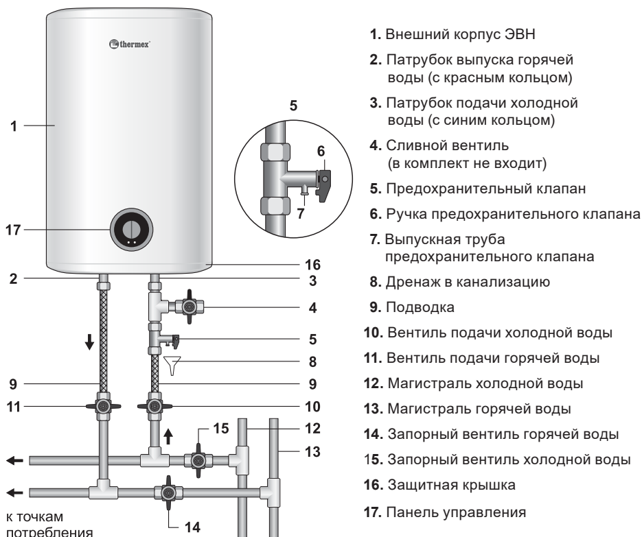
Рисунок 2. Схема подключения ЭВН к водопроводу.
